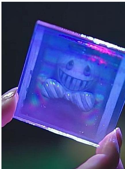
*Hologramme de Denisyuk observé par transmission sous un spot, après blanchiment et avant séchage.*
